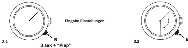
Nochmals B drücken um die lokalen Gezeiten einzugeben. Kontinuierliches drücken von B ermöglicht eine schnelle Einstellung. Ohne drücken von 3 Sekunden auf B, signalisiert ein Piepton das Aussteigen aus dem Einstellungsmodus.
